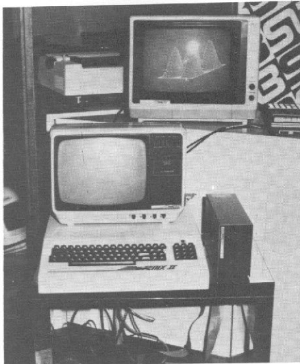
Fenix II: CPU Z80A; 16K RAM, mais 16K para resolução gráfica; cassette ou disquete (de 5 ou 8"); vídeo preto e branco ou colorido. Preço da configuração mínima: Cr$ 490 mil
